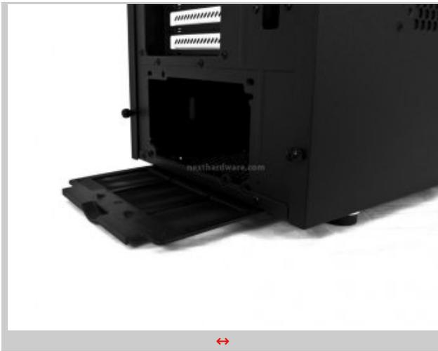
Dettaglio del filtro antipolvere posto alla base del case facilmente removibile e lavabile sotto acqua corrente.
