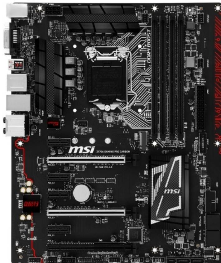
Tra le caratteristiche offerte segnaliamo l'immane sistema audio MSI Audio Boost 3, una scheda di rete Intel progettata per il gaming online, la presenza di un connettore M.2 Turbo e, infine, gli slot PCIe con rinforzi in acciaio.
