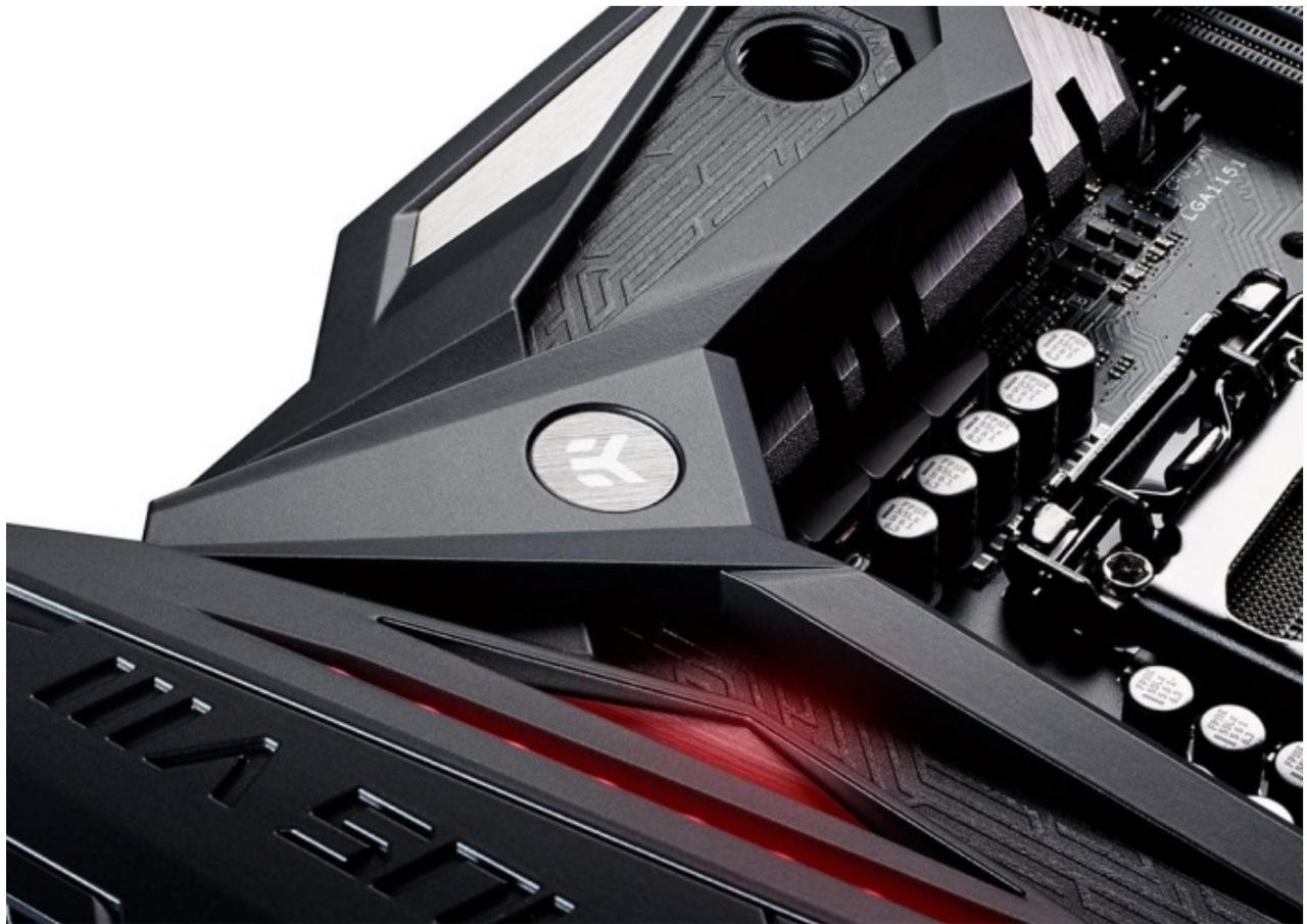
Come nei più recenti modelli di questa fortunata serie, il produttore, in collaborazione con EK, ha dotato questa mainboard di un dissipatore ibrido, denominato CrossChill, posto sulla robusta sezione VRM/MOSFET, in grado di garantire temperature contenute anche in caso di overclock piuttosto spinti.
