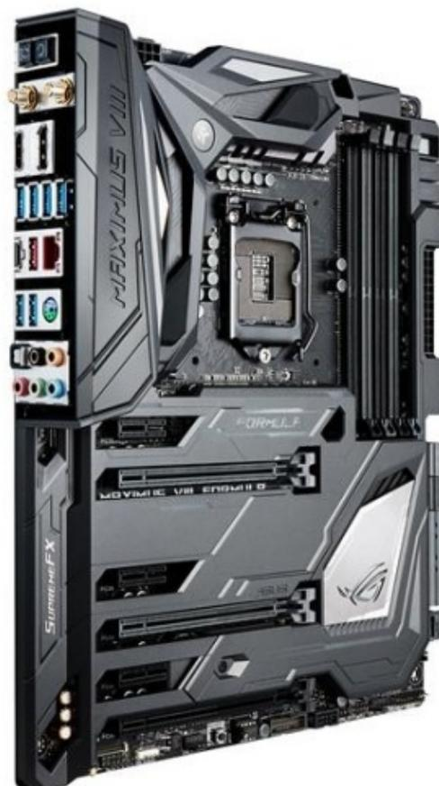
La MAXIMUS VIII FORMULA↔ è alimentata da un connettore EPS 8 pin ed un ATX 24 pin, è dotata di quattro slot DIMM DDR4 per una capacità massima di 64GB ad oltre 3000MHz di frequenza operativa, nonché di tre slot PCI-E 3.0 x16 (x16, x8, x8) e tre slot PCI-E 3.0 x1.
