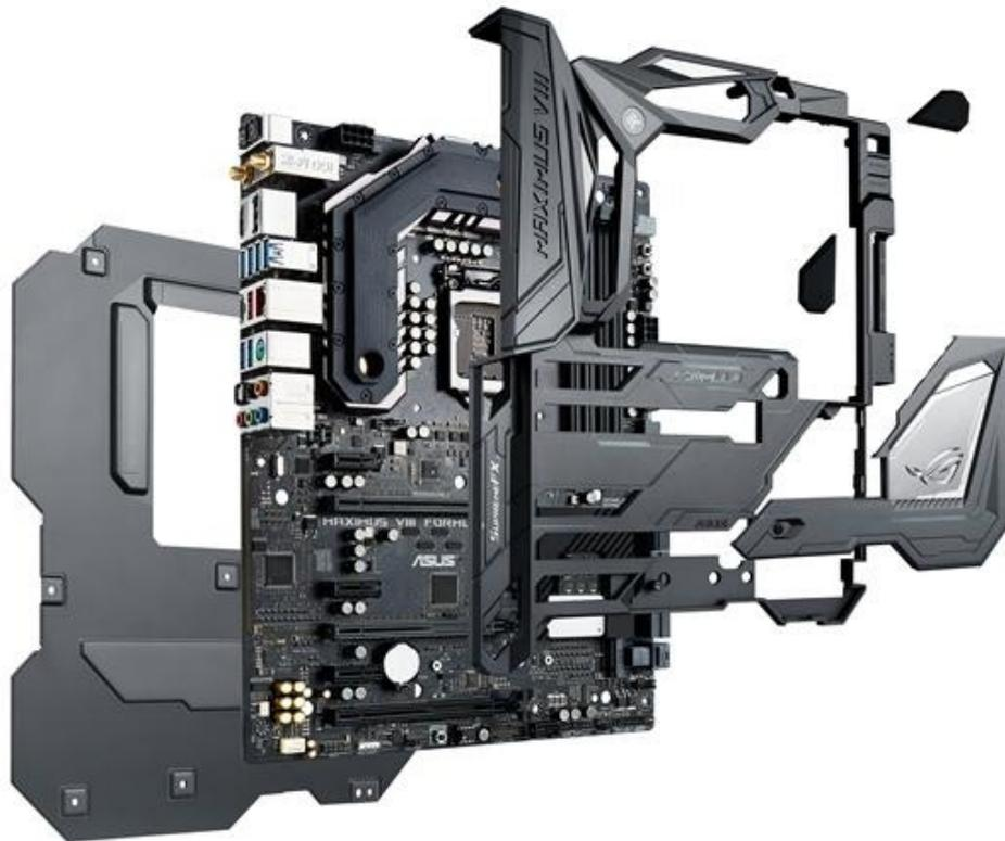
Quest'ultima è composta da due diversi materiali: sul frontale vi è una parte in spesso ABS in modo da garantire temperature più basse bloccando la trasmissione del calore generato dalle schede grafiche, mentre sul retro del PCB troviamo una parte in acciaio SECC atta ad irrobustire la scheda madre nonché, tramite l'interposizione di alcuni pad termici, coadiuvare il raffreddamento della stessa.
