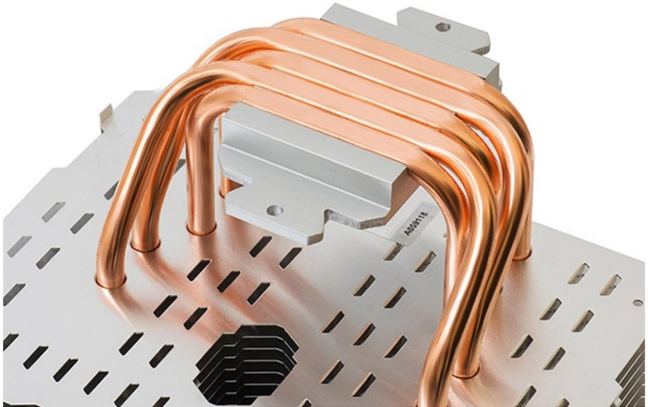
Il robusto dissipatore è collegato alla base tramite cinque heatpipes in rame che, a differenza del solito, sono a diretto contatto con la CPU.
