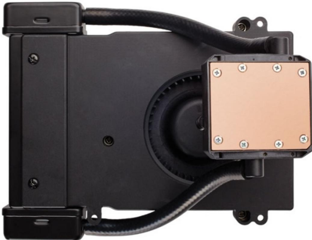
L'ampia base in rame del waterblock va a trasferire il calore prodotto dal processore ad un radiatore integrato da 120mm con uno spessore di 40mm, raffreddato a sua volta da una ventola PWM che lavora in aspirazione sulle zone più calde intorno al socket, dove sono situati generalmente i componenti del VRM.
