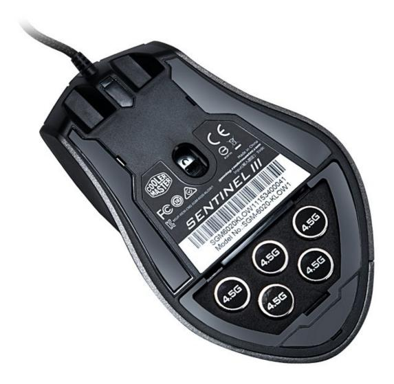
Sotto la base trova posto, inoltre, il solito sistema di regolazione del peso, che si affida a cinque unità da 4,5g da installare con estrema facilità per regolare la risposta del mouse in base alle proprie esigenze.
