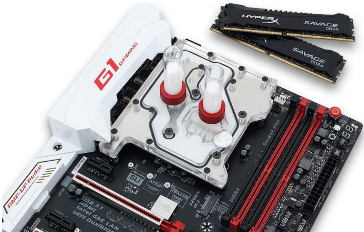
Disegnato e progettato in collaborazione con il produttore taiwanese, il nuovo EK-FB GA Z170X utilizza per il raffreddamento della CPU il performante EK-Supremacy EVO, intorno al quale è sviluppata una soluzione full cover che va ad interessare tutte le altre zone critiche come il circuito di regolazione delle tensioni (VRM).
