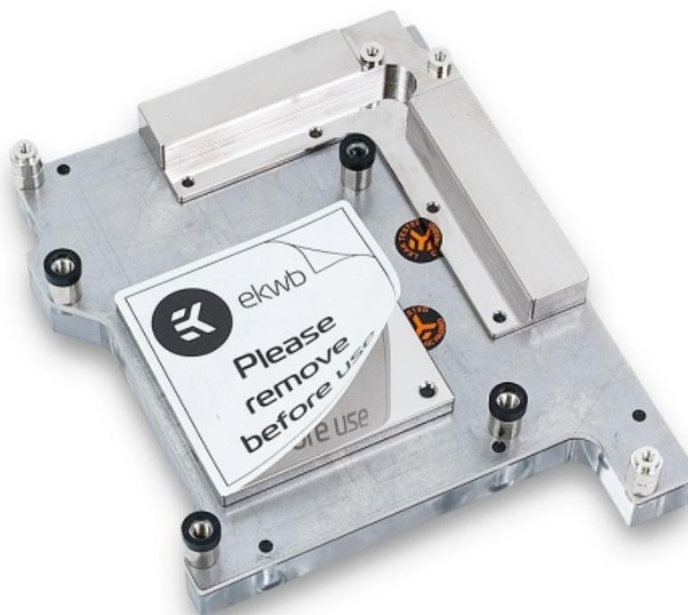
Come di consueto sono previsti i distanziali in ottone preinstallati, in maniera da facilitare e rendere molto più sicura la procedura di montaggio del waterblock.
