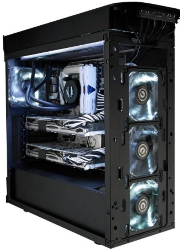
Per gli amanti delle soluzioni di raffreddamento a liquido, il Pandora ATX permette inoltre l'installazione di un radiatore con una lunghezza di 360mm, che può essere posizionato sul top o sul frontale grazie ad una serie di staffe dedicate e di supporti per pompe e serbatoi, che lo rendono ideale per qualsiasi progetto di raffreddamento a liquido.
