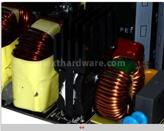
Particolare del doppio ponte raddrizzatore con relativo dissipatore;
