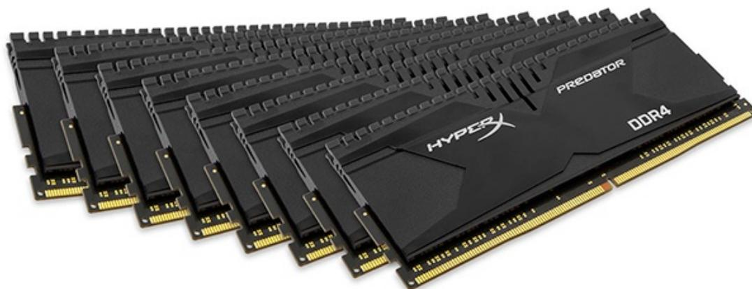
La linea HyperX Predator DDR4, invece, si arricchisce di due kit con frequenza di funzionamento di 3000MHz e capacità da 32GB (16GBx2) e 64GB (16GBx4).
