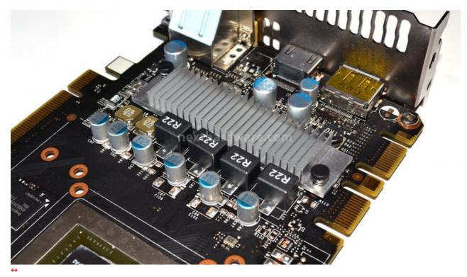
Come già visto sulla GeForce GTX 670, la sezione di alimentazione è posta nella parte anteriore della scheda video ed è dotata di quattro fasi raffreddate da un unico dissipatore in alluminio.
