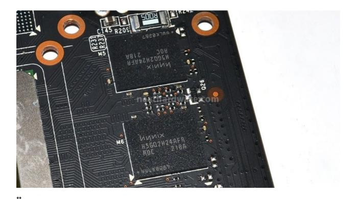
Sei moduli di memoria sono installati sulla parte frontale del PCB, i restanti due sono saldati sul retro.
