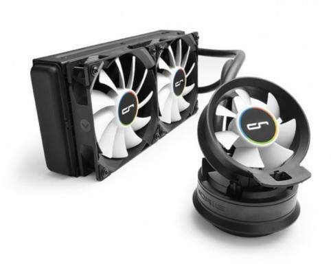
L'A80 è invece un biventola da 280mm, con radiatore predisposto per due ventole da 140mm e con uno spessore di 25mm.
