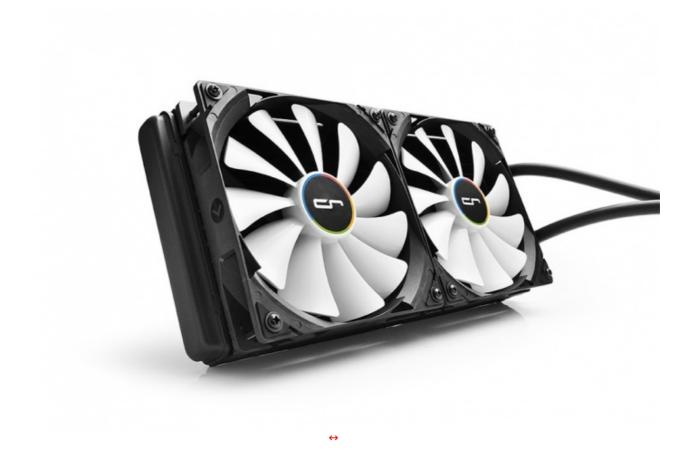
Le ventole utilizzate sono delle QF120/QF140 con design Quad Air Inlet Technology, in grado di garantire un elevato e costante flusso di aria attraverso un fitto corpo lamellare, e sistema a cuscinetti HPNL per diminuire la rumorosità e l'attrito tra girante e rotore.
