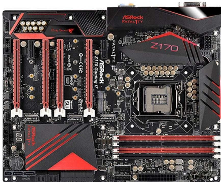
Per quanto riguarda il comparto storage, la mainboard è equipaggiata con dieci connessioni SATA III, tre SATA Express e ben tre slot M.2 Ultra che permettono di ospitare altrettante unità SSD M.2 PCIe anche in configurazione RAID 0.
