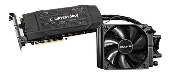
L'unità di raffreddamento a liquido è molto compatta e permette la massima facilità di installazione e nessuna manutenzione nel corso della vita della VGA, mentre il waterblock integrato consente di raffreddare non solo la GPU, ma anche le memorie ed i MOSFET, riuscendo a dissipare attivamente tutto il calore in modo efficiente, senza l'ausilio di alcuna ventola supplementare.
