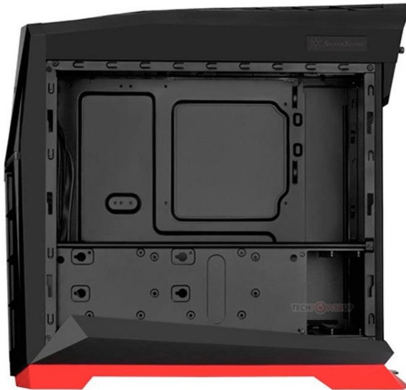
Il sistema di raffreddamento include cinque alloggiamenti per ventole da 120mm, di cui tre posizionati sul fondo (in grado di accogliere anche un radiatore da 360mm), uno anteriore per l'aspirazione↔ e uno sul top per l'espulsione dell'aria.
