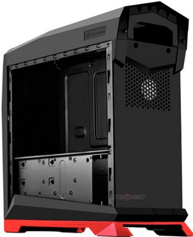
Come da tradizione, il case ha il vassoio centrale ruotato di 90° con il pannello di I/O accessibile dal top e la mainboard dal lato destro.
