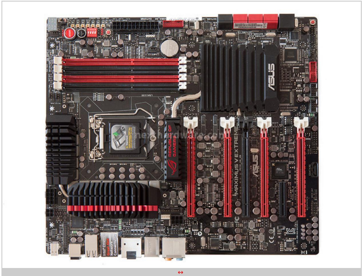
La Maximus V Extreme è basata sul Platform Controller HUB Intel Z77 e adotta il socket 1155 in grado di supportare, oltre alle nuovissime CPU Intel Ivy Bridge a 22nm, anche le CPU Sandy Bridge di precedente generazione.
