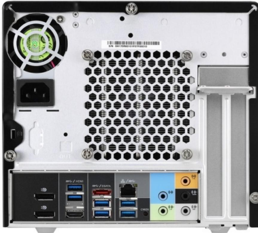
Dall'esterno colpiscono le otto porte USB 3.0, alle quali si aggiungono le uscite per l'audio a 8 canali, due ulteriori porte USB 2.0, una delle quali offre la funzione di carica dei dispositivi mobili, nonché le porte eSATA e Intel Gigabit Ethernet.
