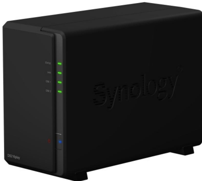
Il DS216play, a sua volta, consente di eseguire la transcodifica hardware di contenuti digitali utilizzando gli standard 1080p H.264 e 4K H.265, trasmettendoli nel formato adatto ad un lettore multimediale, un dispositivo mobile ed un computer, rendendo più semplice la visione dei video senza dover installare lettori di terze parti.
