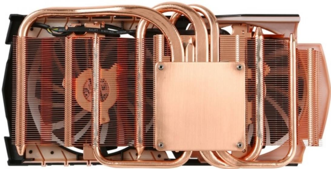
Quest'ultimo, completamente riprogettato e facente uso della tecnologia SuperSU per le heatpipes, è ora in rame (con uno speciale trattamento anti-ossidazione) ed occupa uno slot in meno rispetto alle normali versioni ma, nonostante ciò, è molto più efficiente e silenzioso.
