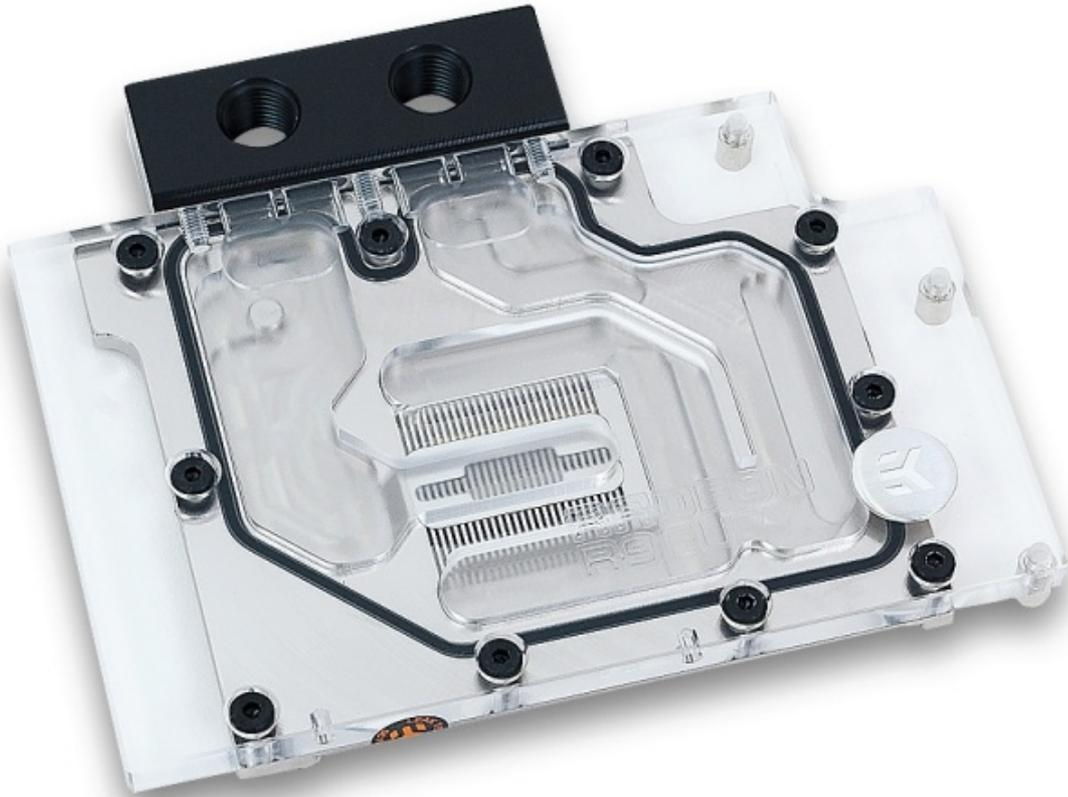
Altra prerogativa del prodotto sono le↔ elevate prestazioni idrauliche in virtù di un design poco restrittivo, che permette di impiegarlo in abbinamento a impianti dotati di pompe non troppo potenti.
