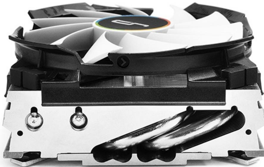
Il fitto corpo lamellare in alluminio, a diretto contatto con la base in rame nichelato attraverso quattro heatpipes dal diametro di 6mm, è raffreddato attivamente da una ventola PWM da 92mm, modello CR-9215, in grado di variare il proprio regime di rotazione dai 600 a 2500 RPM producendo un rumore massimo di 30 dBA con una portata di aria 40,5 CFM ed una pressione statica pari a 2.8 mmH<sub>2</sub>O.
