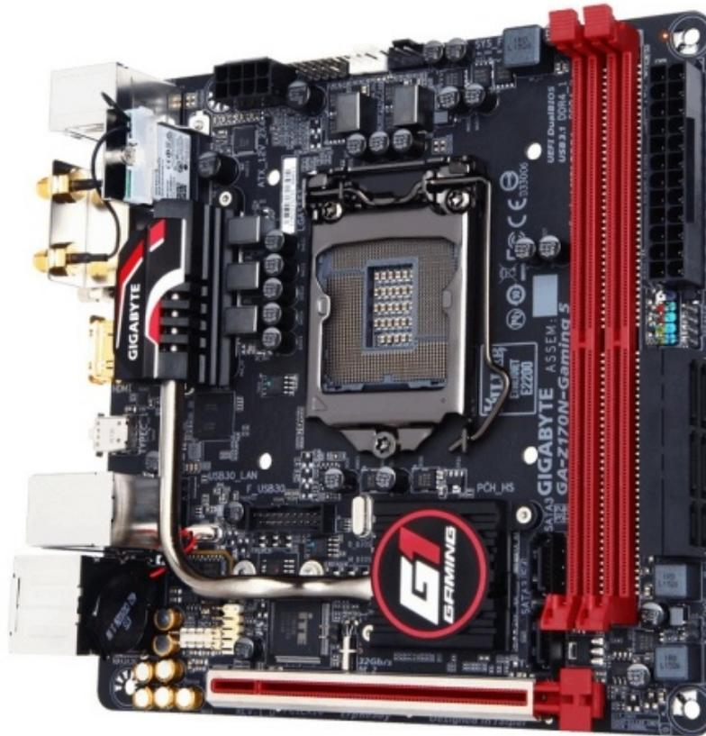
La scheda prevede due slot DIMM a lunghezza intera in grado di ospitare due moduli di memoria DDR4 in configurazione dual-channel per un quantitativo massimo di 32GB ed uno slot PCI-E x16 3.0 decisamente robusto.
