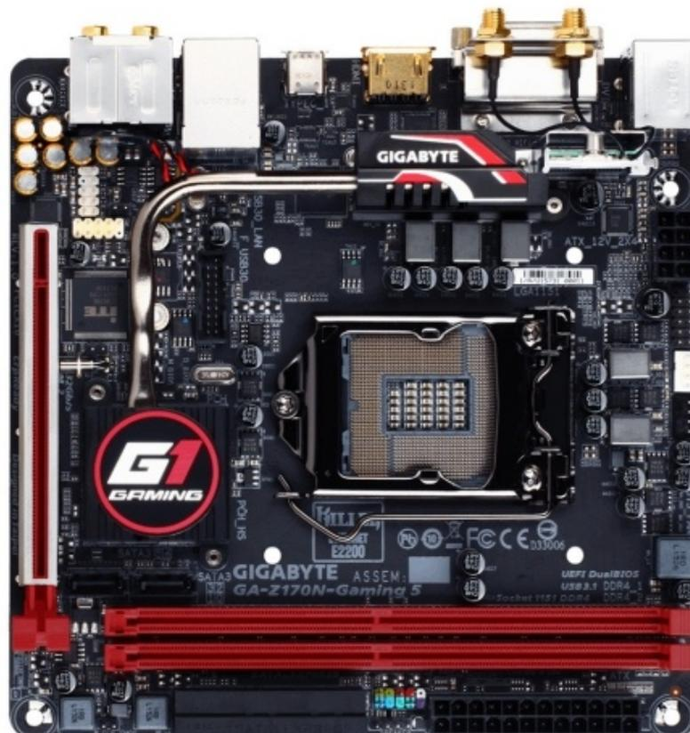
Lato storage troviamo un connettore M.2 con una larghezza di banda teorica di 32 Gb/s, due porte SATA Express 16 Gb/s e sei SATA 6 Gb/s, mentre sul fronte USB abbiamo due porte USB 3.1 (una di tipo A ed una di tipo C), cinque USB 3.0 e quattro USB 2.0.
