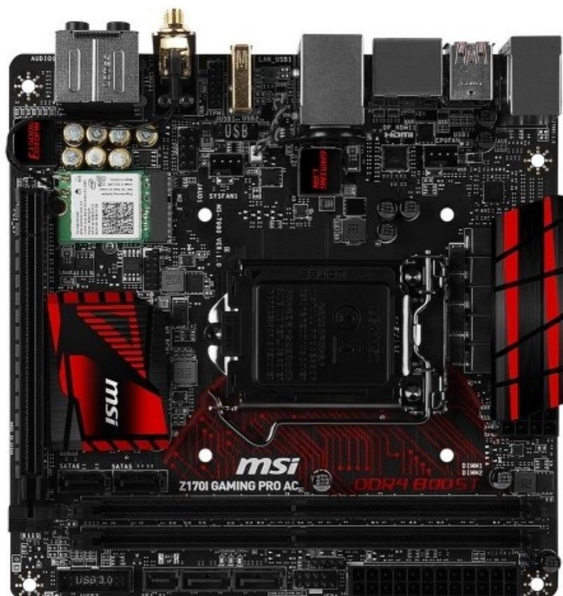
Per quanto riguarda le uscite video, invece, abbiamo una DisplayPort ed una HDMI.
