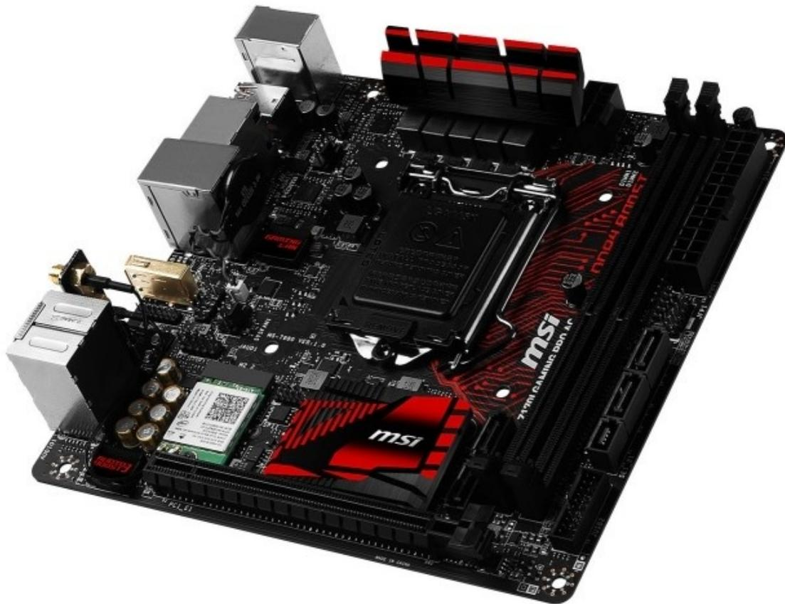
A bordo troviamo due slot DIMM per il supporto di moduli di memoria DDR4 in configurazione dual channel con tecnologia MSI Boost DDR4, un circuito di alimentazione (VRM) a 5 fasi alimentato da un connettore ATX 24pin ed un EPS 8pin, uno slot PCI-E x16, un mPCIe (per la scheda WLAN), un M.2 PCI-E 3.0 x4 in grado di offrire una banda teorica di 32 GB/s, quattro porte SATA 6Gb/s, due delle quali utilizzabili per i dispositivi SATA Express, sei USB 3.0 ed una USB 2.0 ottimizzata per le cuffie.
