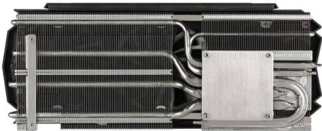
Il dispositivo di raffreddamento è costituito da una grande base in rame nichelato, dalle quali partono cinque heatpipes dello spessore di 8-10 mm che sono a loro volta collegate con un generoso dissipatore alettato in alluminio, il tutto coadiuvato da tre ventole da 100mm.
