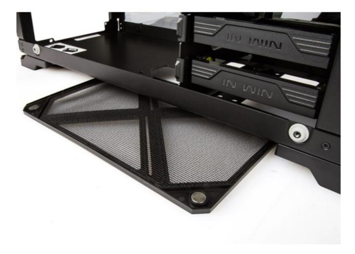
I filtri antipolvere presenti sono tutti dotati di supporti magnetici per una facile rimozione e relativa manutenzione.
