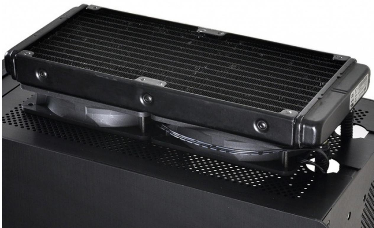
Come se non bastasse, sul pannello superiore è presente una predisposizione per due ventole da 140mm utilizzabile anche per sistemi di raffreddamento a liquido AiO.
