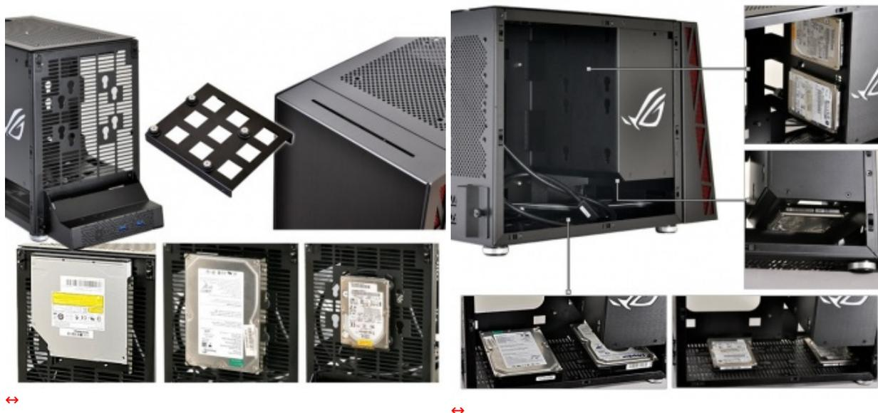
Oltre alla scheda madre ITX trovano spazio un alimentatore ATX, ben sei slot drive da 2,5", di cui quattro utilizzabili per tre drive da 3,5", ed una unità ottica slim di tipo slot in.
