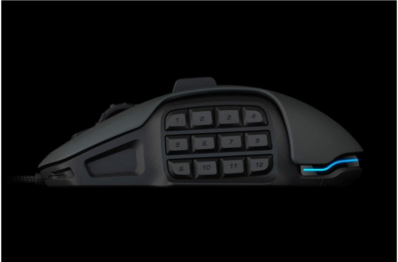
L'aspetto tecnico conterà un sensore di nuova concezione Twin-Tech R1 Laser da 12.000 DPI con microprocessore interno ARM e 576kB di memoria integrata per la memorizzazione di Macro e la mappature dei tasti.
