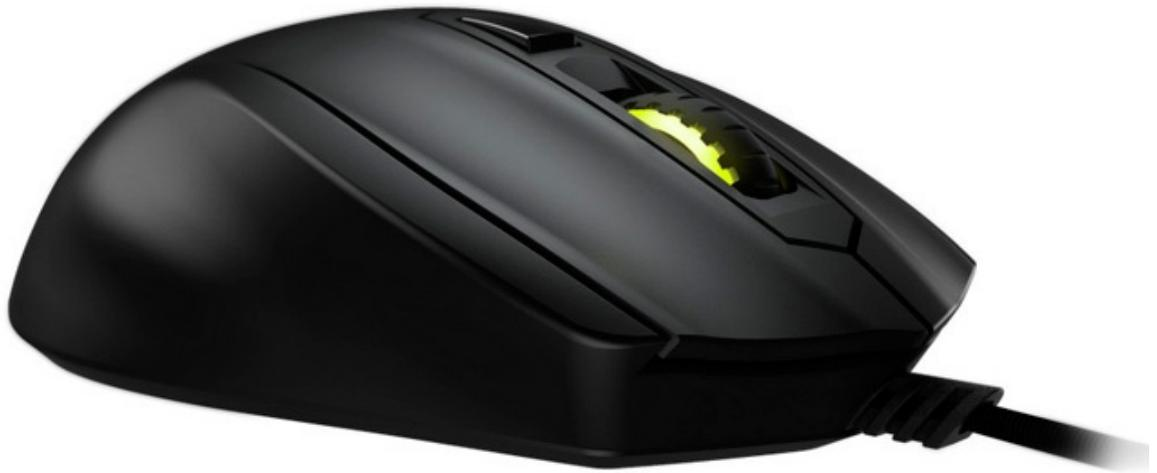
La nuova regolazione della LOD (Lift-off Distance, distanza di spegnimento) legge i risultati dall'algoritmo di analisi della superficie S.Q.A.T. per trovare la minima distanza utilizzabile senza alcun effetto controproducente per la qualità del tracciamento.
