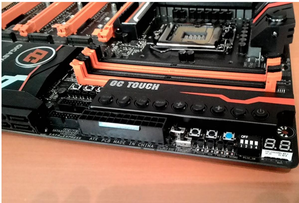
Il socket LGA1151 della CPU è collegato a quattro slot DIMM che supportano fino a 64GB di memoria dual-channel DDR4 sino a 3200MHz.
