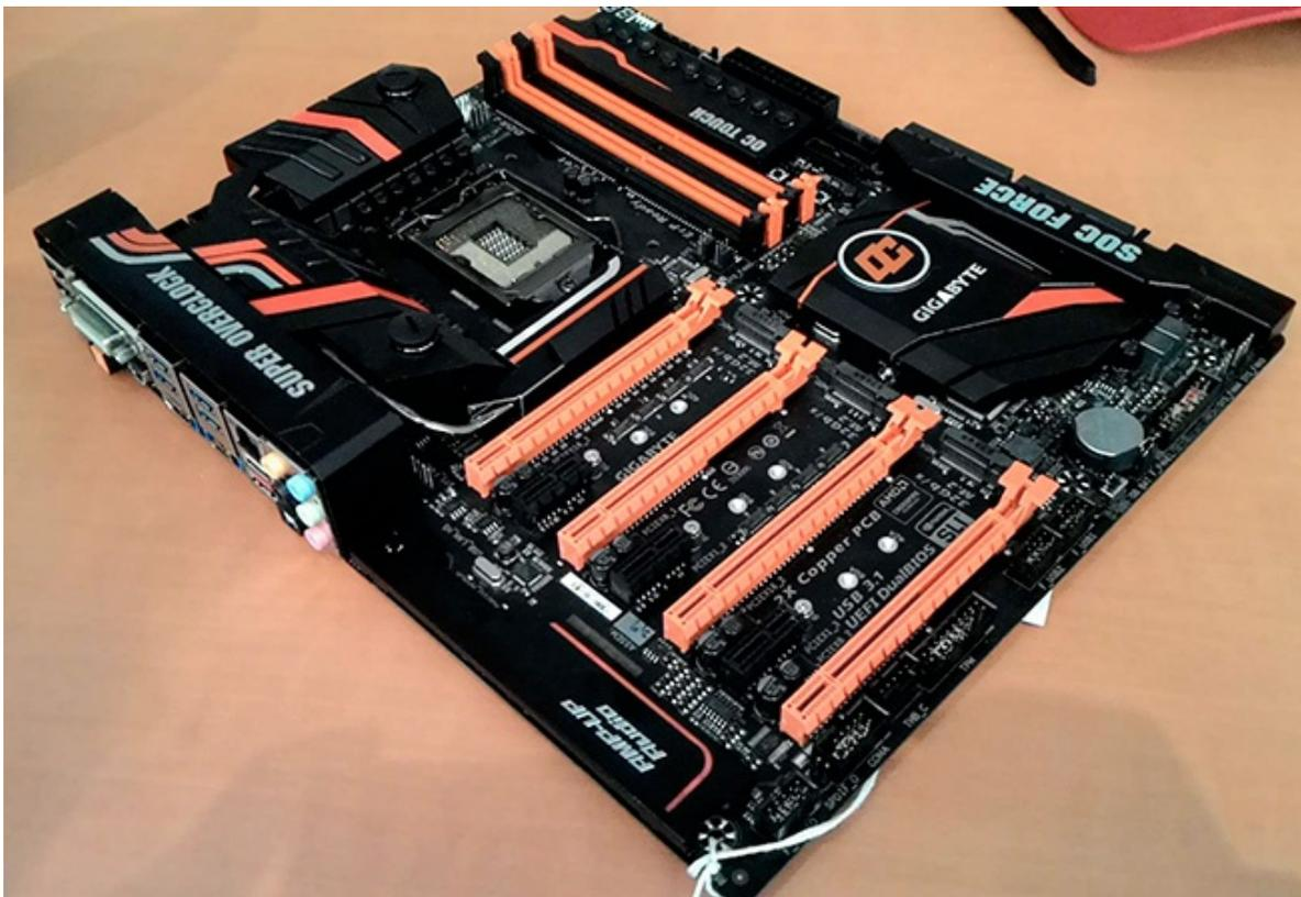
Dotata di un fattore di forma ATX standard, questa particolare scheda con chipset Intel Z170 offre una robusta sezione di alimentazione a 24 fasi per CPU e memorie, nonché caratteristiche di connettività che non fanno rimpiangere i modelli gaming dello stesso produttore.
