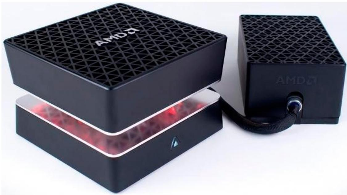
Il sistema, nato per essere una dimostrazione dei punti di forza delle GCN 1.3 "Fiji", integra al suo interno ben due GPU raffreddate da un circuito a liquido, deputato, peraltro, anche al raffreddamento della CPU.
