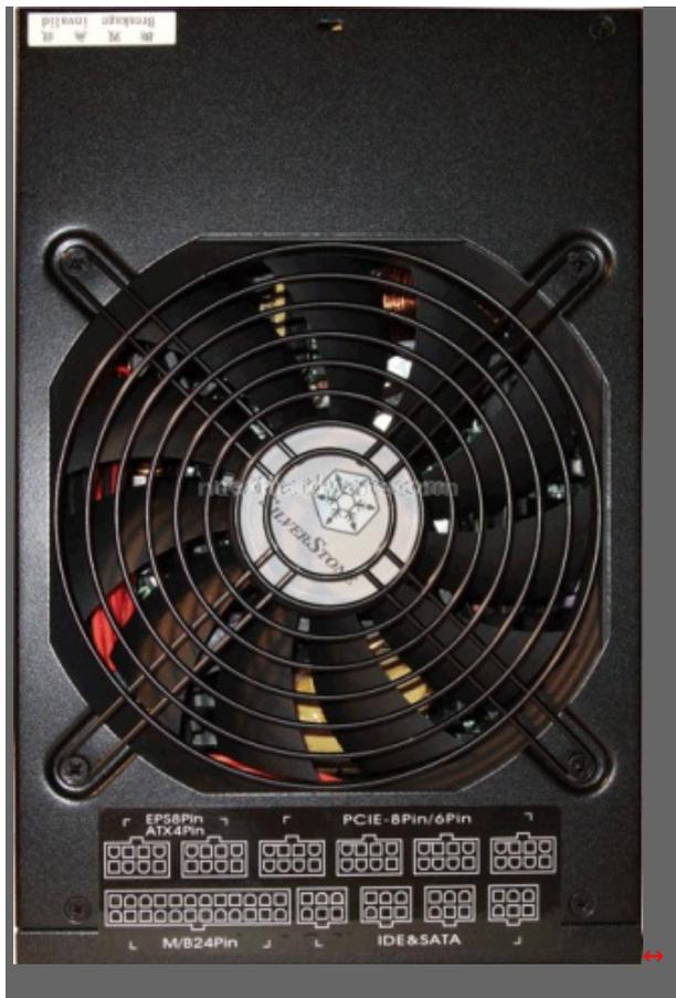
Ecco l'unica protagonista del sistema di dissipazione, 135mm e ottima silenziosità . Sembra incredibile possa gestire i 1200W di questo alimentatore.
