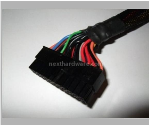
Uno dei pochi alimentatori fornito con cavo ATX24pin modulare.
