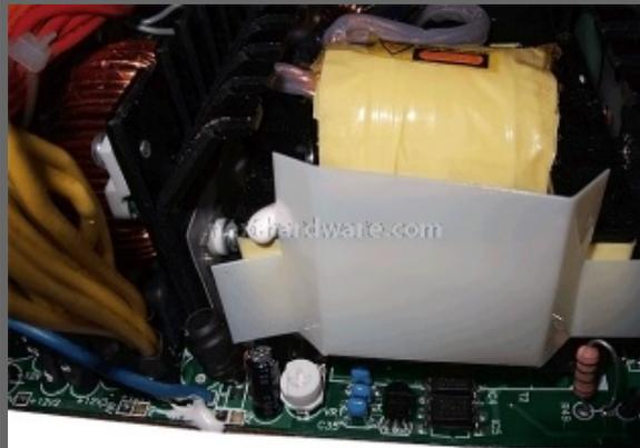
Nonostante sia necessario aprire il cabinet dell'alimentatore invalidando quindi la garanzia, Silverstone ci da la possibilità di settare a nostro piacimento i trimmer di regolazione per le 3 linee di alimentazione principali.
