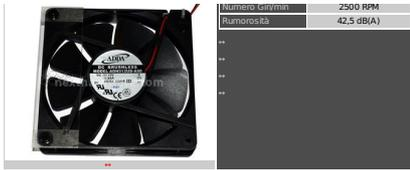
La ventola, particolarmente robusta e performante, non dispone tuttavia del controllo PWM, è quindi necessario agire sulla sola tensione per regolarne la velocità di rotazione.
