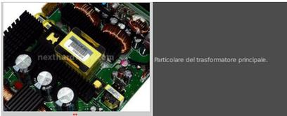
Una volta ridotta la tensione a valori compatibili con gli stadi successivi, è necessario filtrare le forti oscillazioni prodotte dai transistor di switching.
