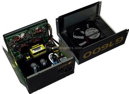
Rimosse le otto viti che vincolano la cover superiore allo chassis, possiamo dare uno sguardo alla struttura interna del LEPA G1600-MA.
