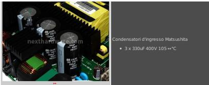
I condensatori d'ingresso impiegati sono tre: si tratta di elementi elettrolitici certificati per operare a 105+°C e 400V di picco.
