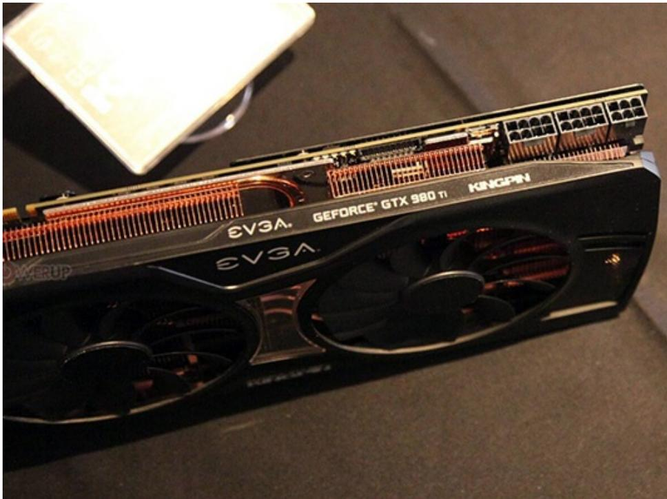
Rispetto alla versione standard, questo modello è dotato di un PCB più grande, anche se non alto come quello della ASUS Strix, ed è alimentata da una combinazione di tre connettori PCIe, di cui uno a 6 pin e due a 8 pin.
