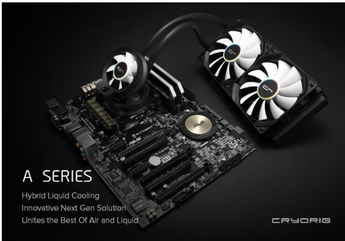
Durante il Computex 2015 è stata presentata la A Series, composta da tre sistemi a liquido con radiatore biventola ed una terza ventola adibita al raffreddamento della zona d'alimentazione della CPU e delle RAM.
