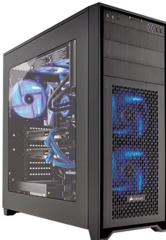
Il case, tutto sommato identico alla versione base, è progettato per consentire l'assemblaggio di un PC in modo rapido e semplice grazie a caratteristiche quali gli speciali pannelli laterali removibili, gli alloggiamenti tool-less per le unità di storage, gli anelli posizionati nelle vicinanze delle asole passacavo, i
