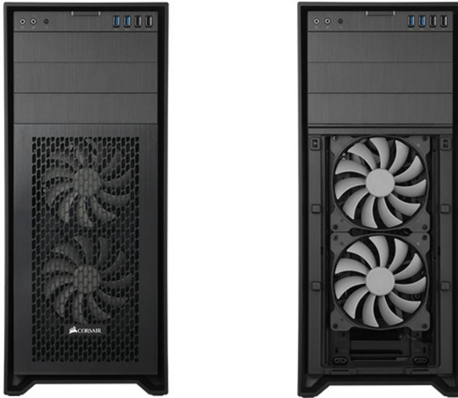
Per far ciò, il frontale vede, al posto di un pannello, la presenza di una griglia d'aerazione proprio davanti alle due ventole AF140L da 140mm.
