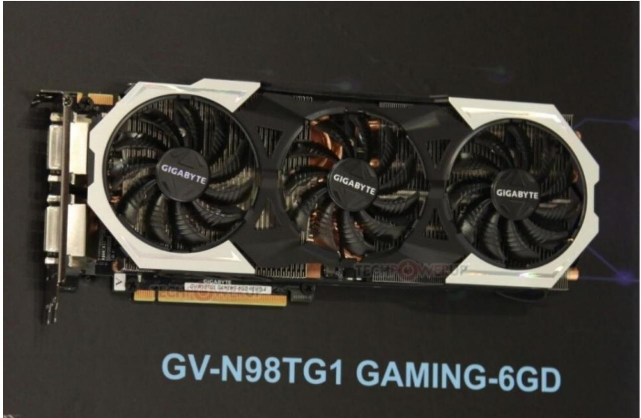
Il dissipatore, mostrato al Computex con una insolita livrea nera e bianca, consta di un generoso elemento in alluminio a due corpi indipendenti abbinato a sei heatpipes di cui cinque da 8mm ed una da 6mm a diretto contatto con la GPU.
