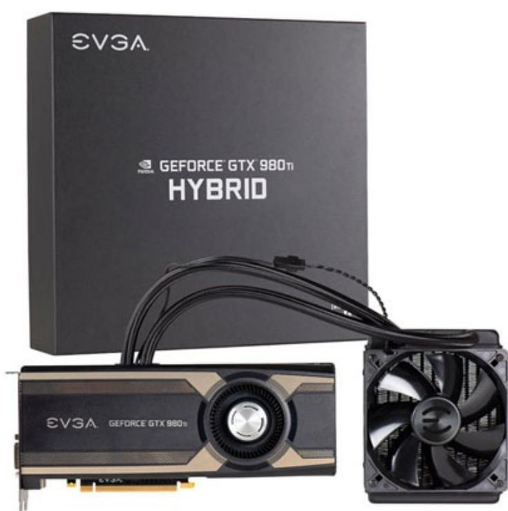
Insieme ad Inno3D, EVGA è l'unico produttore, per ora, a mostrare una soluzione ibrida (aria e liquido) con radiatore da 120mm.
