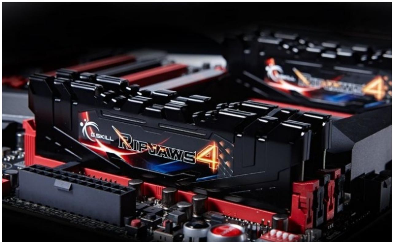
Le nuove performanti DDR4 sono equipaggiate con selezionatissimi ICs di produzione Samsung da 4Gb e sono in grado di funzionare alle frequenze di targa con timings pari a 18-18-18-38 2T e soli 1,35V di tensione operativa.
