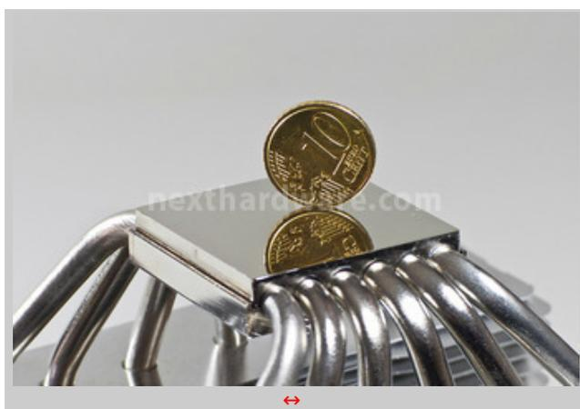
Molto buone le finiture, ottima la base, dove troviamo le heatpipes saldate ed una superficie di contatto con la CPU lucidata a specchio in modo impeccabile.
