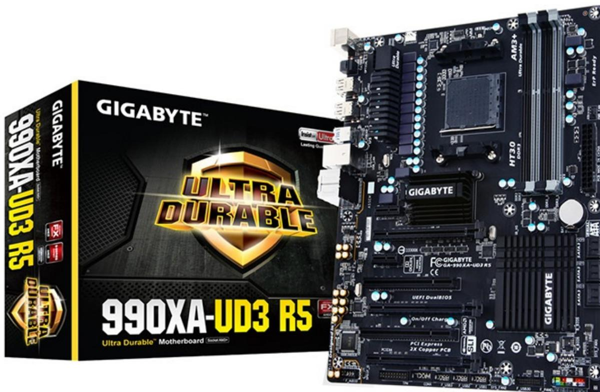
GIGABYTE ha presentato la 990XA-UD3 R5, un nuovo modello di scheda madre dotata di socket AM3 + dotata di form factor ATX standard.
