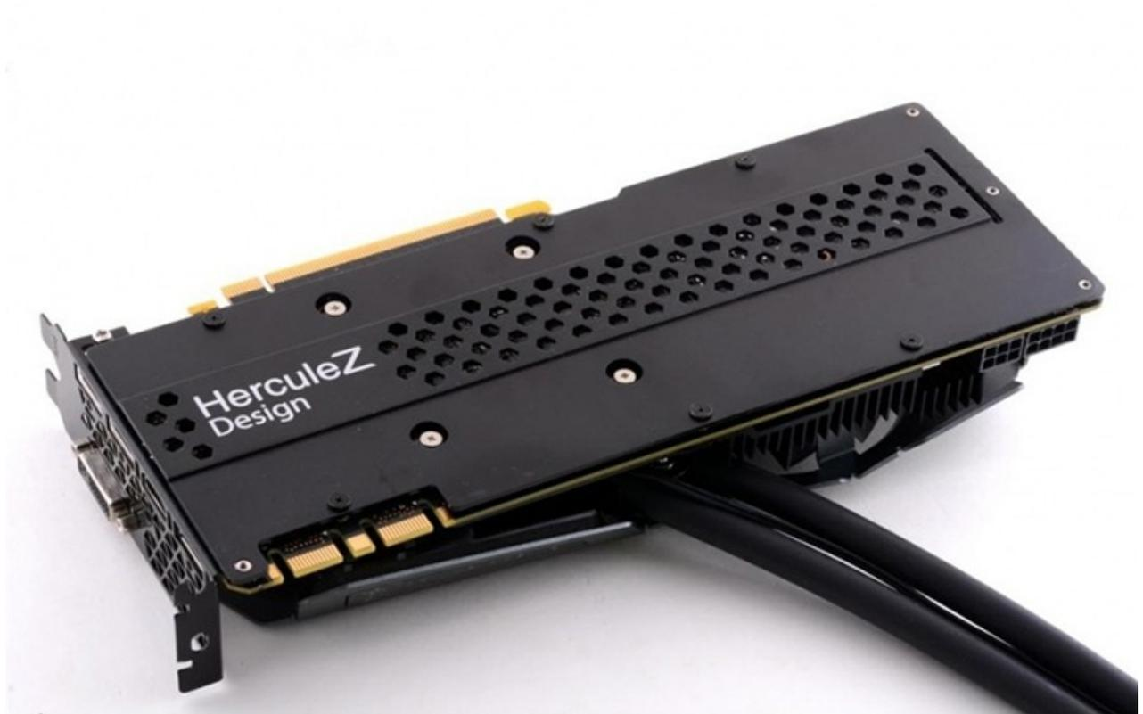
Il dissipatore prevede un waterblock sulla GPU abbinato ad un radiatore da 120mm con relativa ventola ed un corpo dissipante ad aria coadiuvato da una seconda ventola da 100mm, con il compito di raffreddare le GDDR5 ed il VRM.
