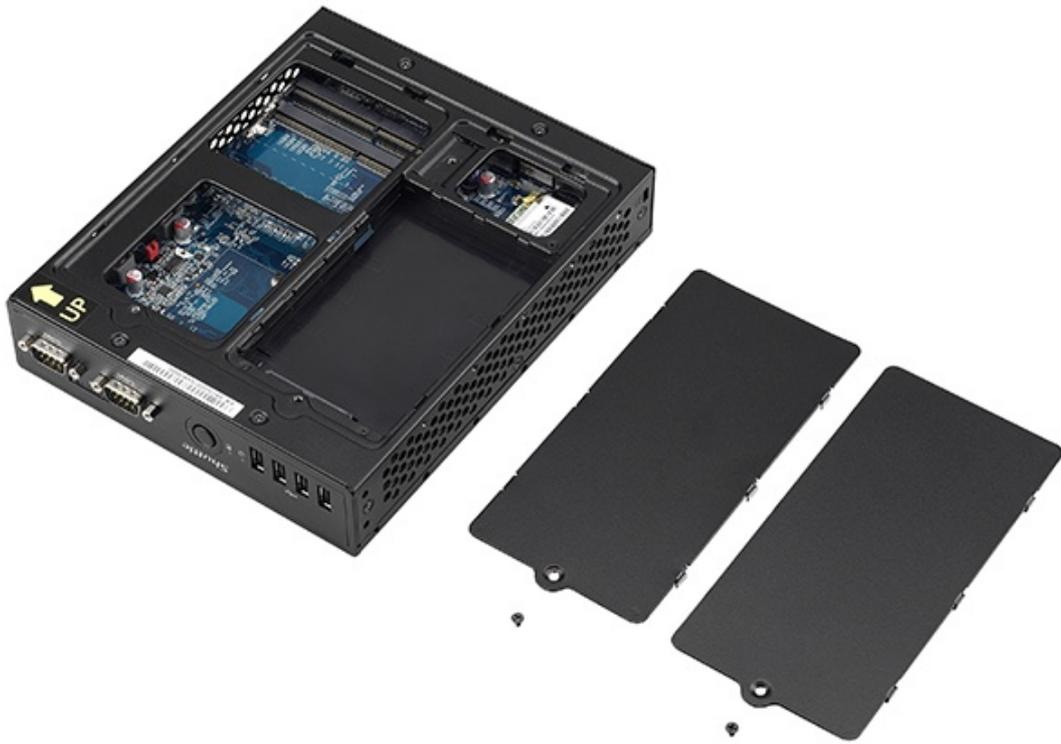
L'apertura del sistema avviene tramite la rimozione di due viti che bloccano altrettanti pannelli in metallo; all'interno troviamo lo spazio necessario per l'installazione di un drive da 2.5" di tipo meccanico o a stato solido e due slot SO-DIMM in grado di ospitare fino a 16GB di memoria DDR3L.↔
