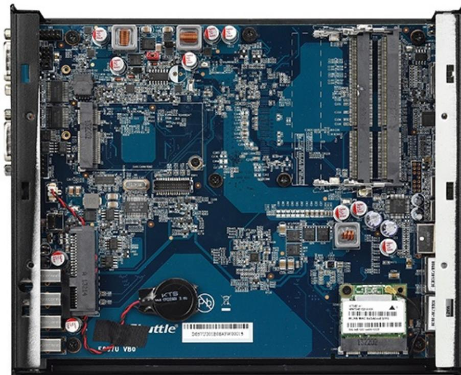
L'espandibilità è garantita dalla presenza di uno slot Mini-PCI Express full-size in grado di ospitare, ad esempio, un dispositivo mSATA, mentre un secondo slot Mini-PCI Express (half-size) è già occupato da un modulo WLAN.
