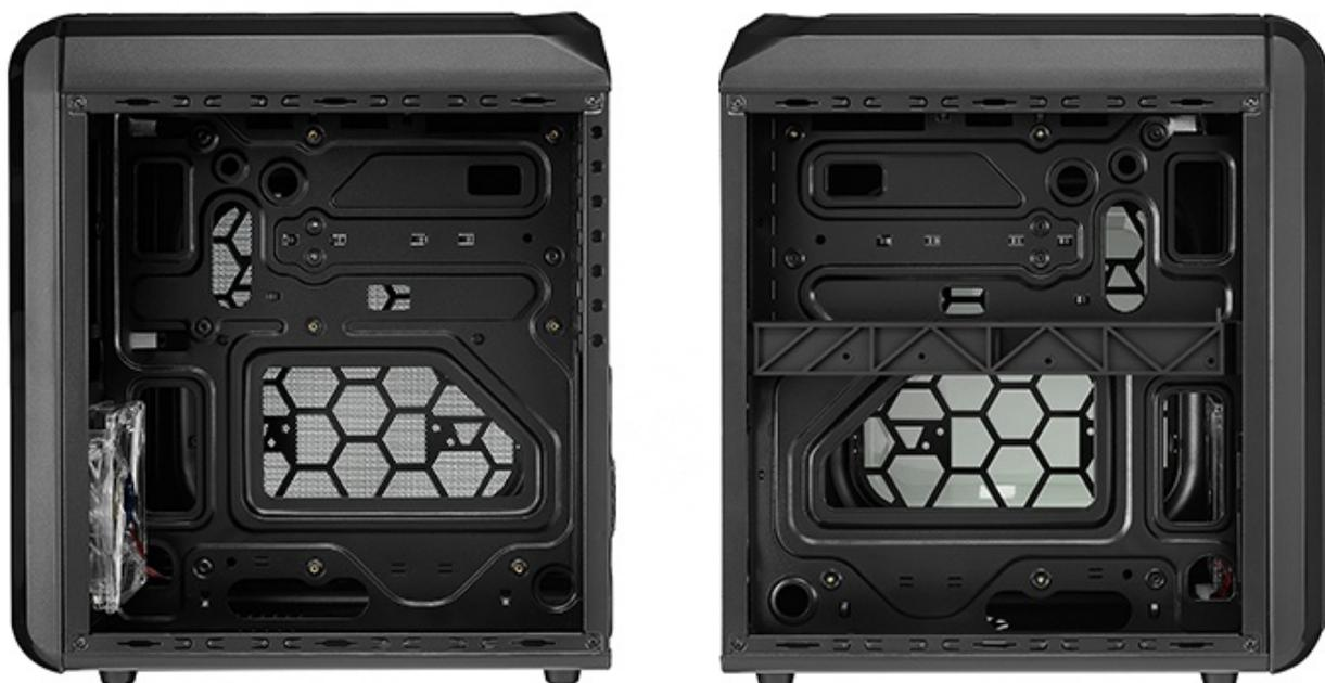
Nonostante le dimensioni simili al microATX DS Cube, da noi recensito poco più di un anno fa ([link \(/recensioni/aerocool-ds-cube-878/\)](#)), il GT-RS è in grado di contenere una scheda madre in formato ATX, schede video lunghe fino a 300mm e un dissipatore per CPU alto 121mm.
