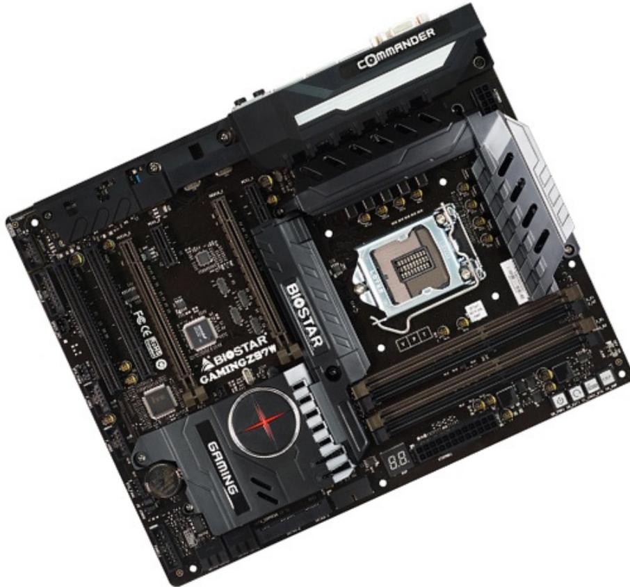
La scheda, inoltre, mette a disposizione anche un paio delle recentissime porte USB 3.1 Turbo, sei porte USB 3.0 e un buon numero di USB 2.0.
