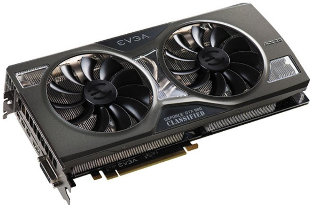
La scheda grafica è espressamente progettata per l'utilizzo in overclock estremo ed utilizza un sistema di alimentazione a 14 + 3 fasi con controllo completamente digitale, in grado di fornire fino a 600A di corrente, il tutto attraverso tre connettori, 8pin + 8pin + 6pin.
