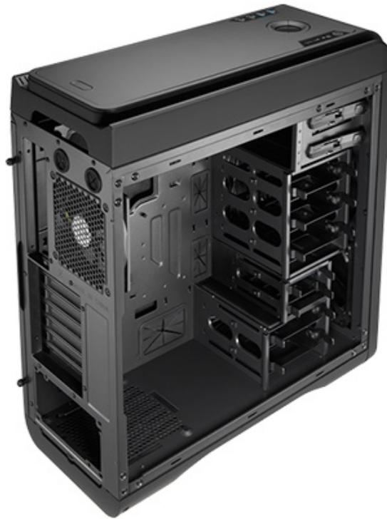
All'interno c'è spazio sufficiente ad ospitare schede grafiche con lunghezza fino a 290mm, che aumenta fino a 410mm previa rimozione di uno dei cestelli per HDDs, mentre l'altezza massima dei dissipatori per CPU è invece di 170mm.
