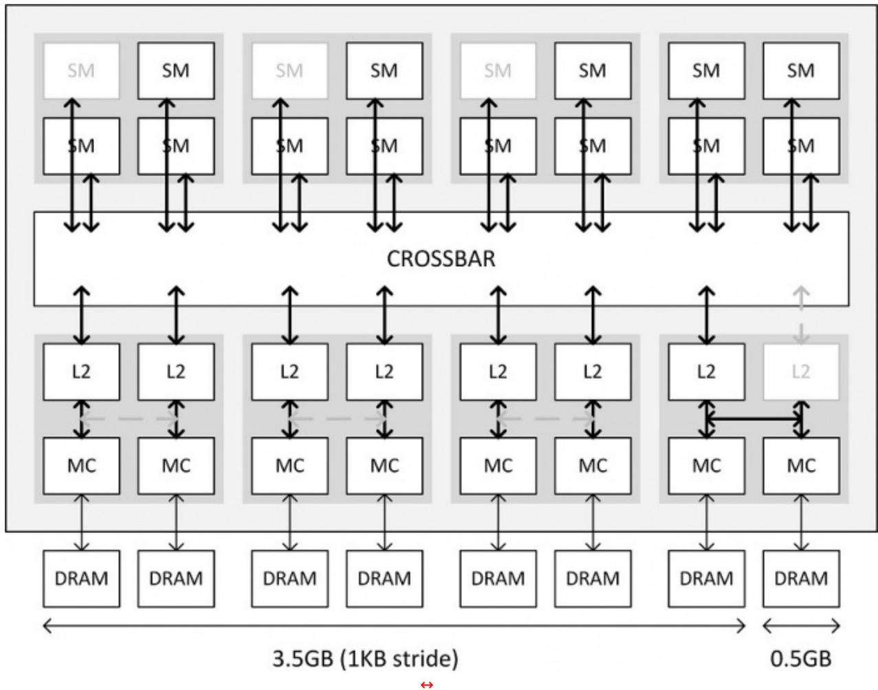
Dallo schema è possibile vedere le 13 unità SMM attive, il controller crossbar, i 7 canali di comunicazione con la cache L2 (che ridotta di un blocco scende quindi a 1792 KByte), gli 8 controller di memoria e gli altrettanti chip di GDDR5, con relativo partizionamento, a cui sono collegati.
