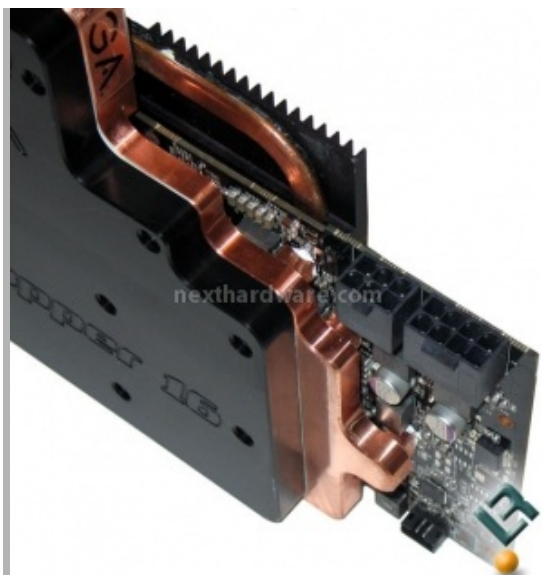
Particolare delle Heatpipe della backplate
