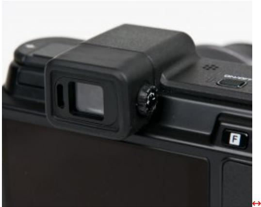
L' **EVF integrato** nel corpo è una matrice LCD a colori da 1,44Mdots caratterizzata da tempi di refresh sorprendentemente buoni, ad ulteriore conferma che le ultime generazioni di mirini elettronici si sono evolute immensamente rispetto al passato.
