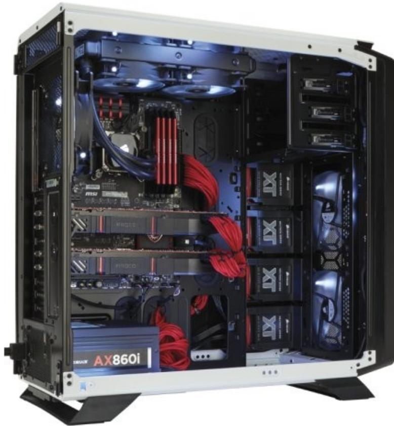
Grazie ad un sottile chassis di appena 7mm di spessore, le unità Neutron XT possono essere installate in modo semplice in qualunque PC desktop o notebook dotato di un alloggiamento da 2,5".
