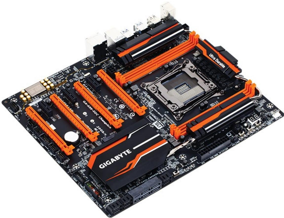
Una delle caratteristiche che la contraddistinguono è infatti il design degli slot DIMM, che sono soltanto quattro al fine di ridurre al minimo la distanza dal socket ed avere la massima qualità dei segnali elettrici.
